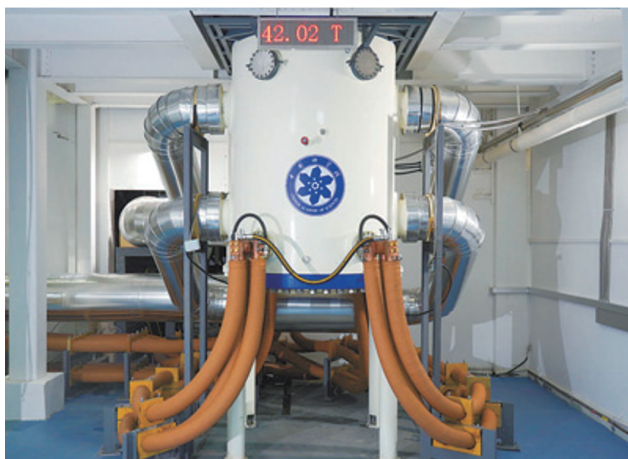
图25 水冷磁体产生42.02 T强磁场 (图片来源:中国科学院合肥物质科学研究院强磁场科学中心)
