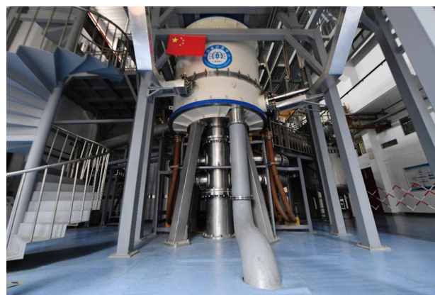
图2 稳态强磁场实验装置混合磁体
