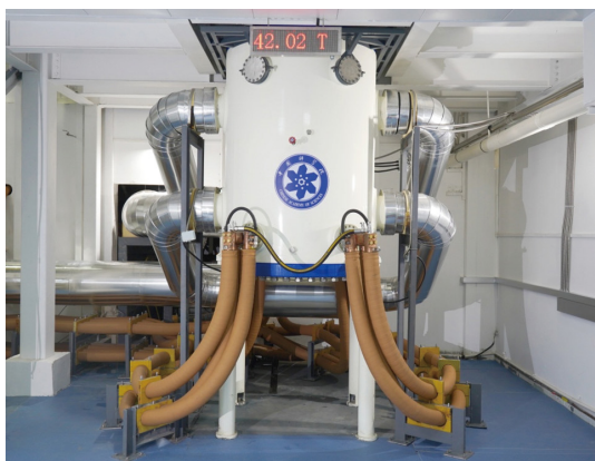
图3 产生 42.02 T 稳态磁场的水冷磁体
