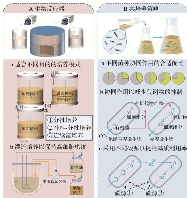
图 6 调控胞外代谢产物以促进生物反应器中化能自养细菌固碳
