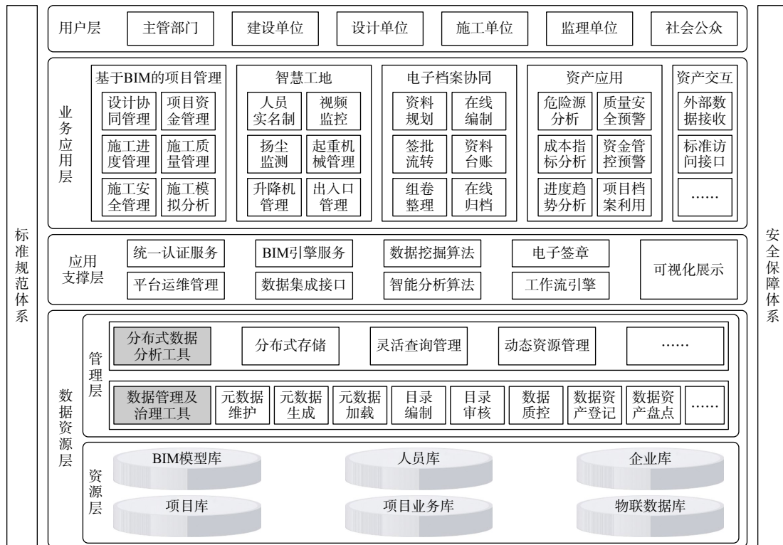
图 4 融合 BIM 的建设信息资产管理平台架构
