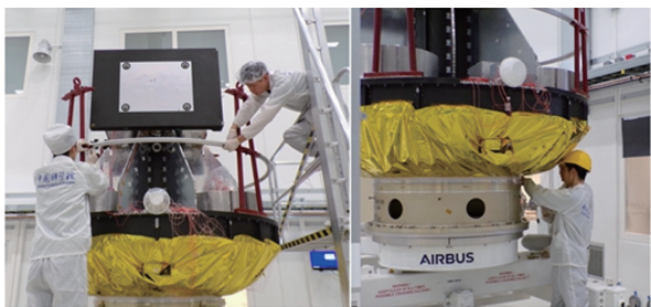
图3 2023年2月,SMILE在欧洲空间技术中心(ESTEC)整星装配与星箭试验
