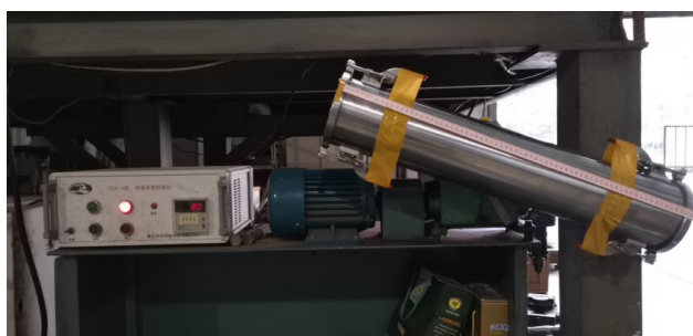
图2 合金抗碎性和耐磨性评价转鼓实验装置
