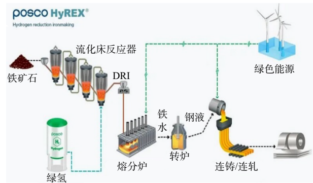
图3 氢还原直接炼铁技术
