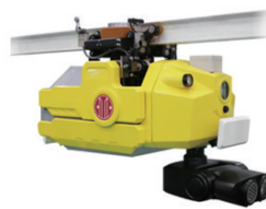
(e) 防爆轨道巡检机器人
