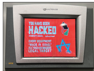
图1 以色列生产的 Unitronics 可编程逻辑控制器遭伊朗黑客组织 CyberAv3ngers 控制
