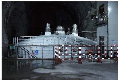
图29 位于中国锦屏地下实验室(CJPL)二期的中国暗物质实验CDEX-1T大型液氮恒温器 (图片来源:雅砻江流域水电开发有限公司)
