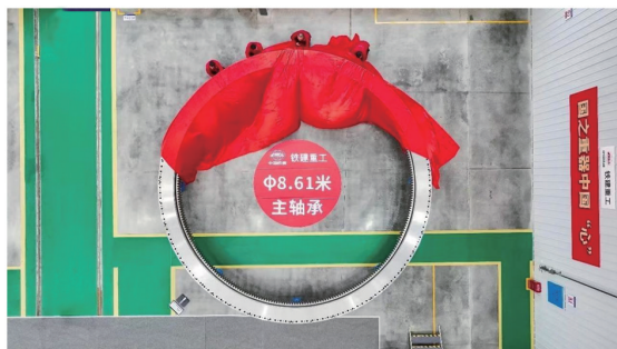
图27 直径8.61 m盾构机主轴承 (图片来源:央视新闻)
