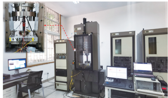
图4 MTS815岩石力学测试系统
