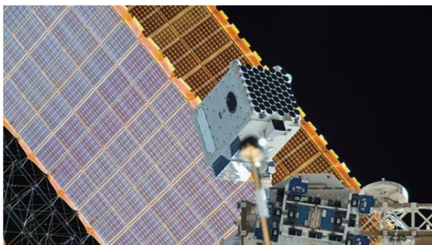
图2 安装在国际空间站舱外的中子星内部构成探测器 (图片来源:NASA网站)
