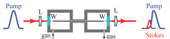
(a) 单脉冲方案,泵浦脉冲是变换极限或者含有一定的啁啾量
