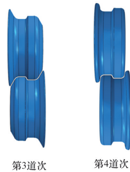
图7 轧辊几何模型示意图
