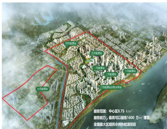
图 4 南京市江北新区的江水空调项目规划示意
