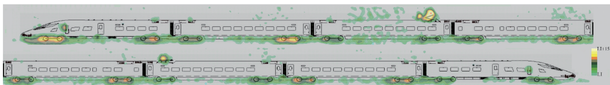
图17 CR400动车组车外噪声源声强级分布云图
