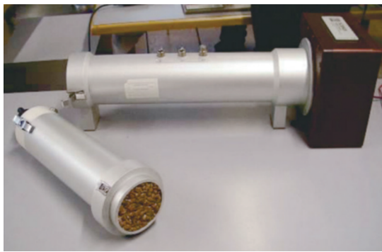
图18 装入阻抗管中的样品示意
