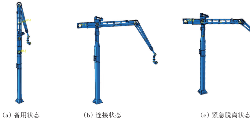
图2 卸料臂备用、连接和紧急脱离状态
