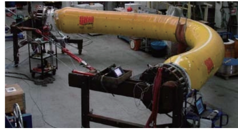
图12 Queau等的卧式弯曲实验
