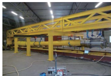
图27 Frohne等的全尺寸动态弯曲疲劳实验
