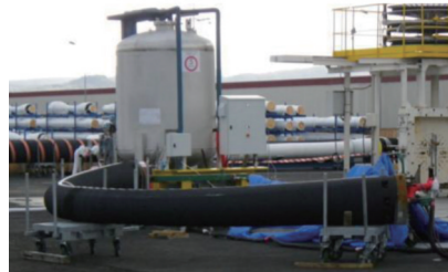
图 20 Lagarrigue 等的 0.3 m 内径弯管低温压力实验
