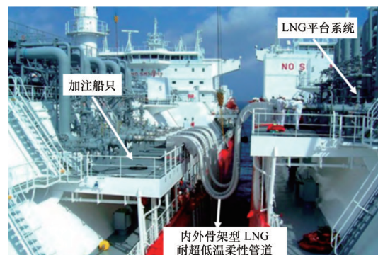
图4 典型的内外骨架型 LNG 耐超低温柔性管道应用环境
