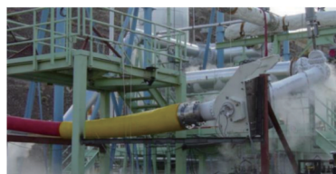
图28 Eide等的全尺寸动态弯曲疲劳实验
