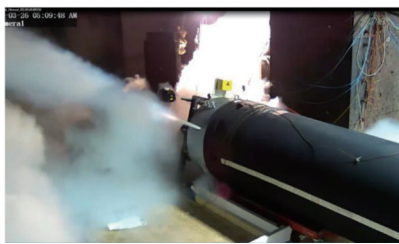
图22 Giacosa 等的低温爆破实验
