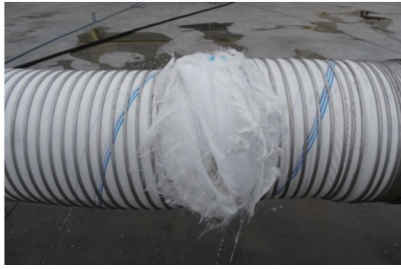
图21 Lagarrigue 等的0.5 m内径管道爆破实验
