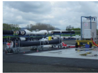
图 19 Lagarrigue 等的 0.3 m 内径直管低温压力实验
