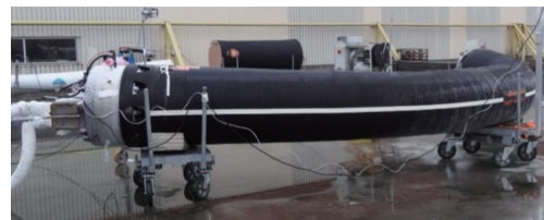
图14 Giacosa等的卧式低温弯曲实验
