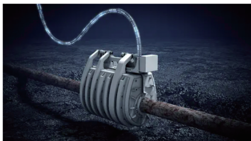
图 11 水下 3D 打印修复技术
