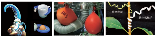
(a) 仿生吸盘机械手 (b) 双模块机械手 (c) 仿植物卷须机械手
