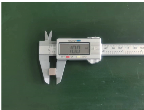
图5 验证实验中使用的钕铁硼立方尺寸
