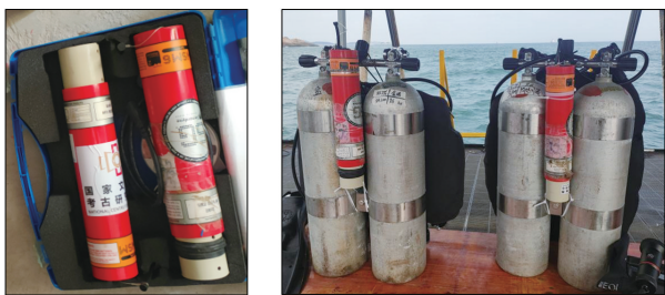
图3 超短基线定位信标及安装方式
