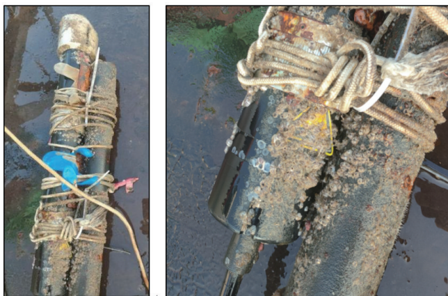
图12 仪器长期在水下布设后附着有大量海洋生物
