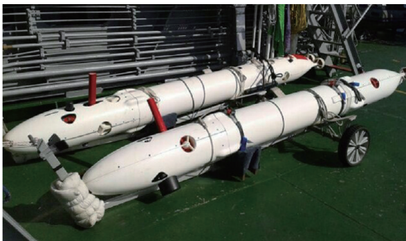
图6 Typhoon系列水下考古AUV
