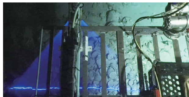
图4 水下高精度三维激光扫描 (图片来源:国家文物局考古研究中心)
