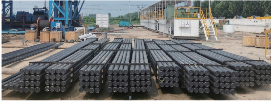
图12 直联式薄壁绳索取心钻杆
