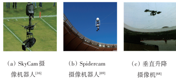
图 6 应用在高速摄像领域的绳牵引并联机构
