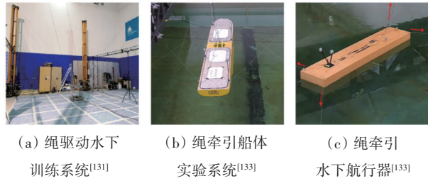
图17 水下航行模拟领域的绳牵引并联系统
