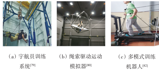
图7 应用在运动模拟领域的绳牵引并联机构
