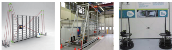
(a) 绳驱动存储检索系统 [137] (b) 绳驱动机架式给料机 [138] (c) 绳牵引码垛机 [140]
