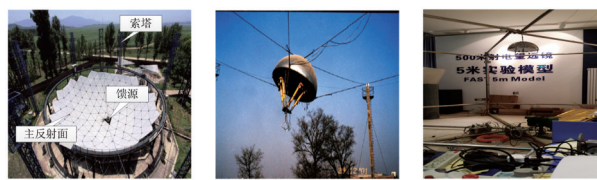
(a) 室外40 m缩尺模型 [43] (b) 室外50 m缩尺模型 [45] (c) 室内5 m缩尺模型
