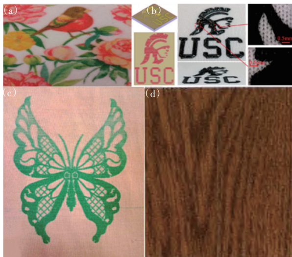
(a) 压电式微滴制备技术彩印的花鸟; (b) 压电推杆式微滴制备技术打印的字母; (c) 压电式微滴制备技术打印的蝴蝶; (d) 压电式微滴制备技术打印的木纹
