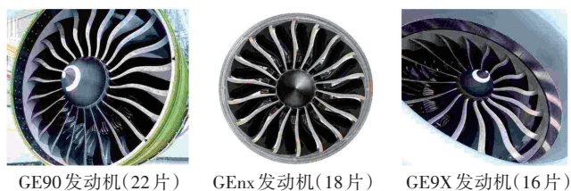
图7 GE航空发动机风扇叶片的发展
