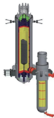
图1 HTR-PM球床模块式高温气冷堆设计模型
