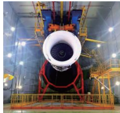
图42 马德里国家航空航天研究所(INTA)的发动机试验台设施后面的光学安装框架(红色)
