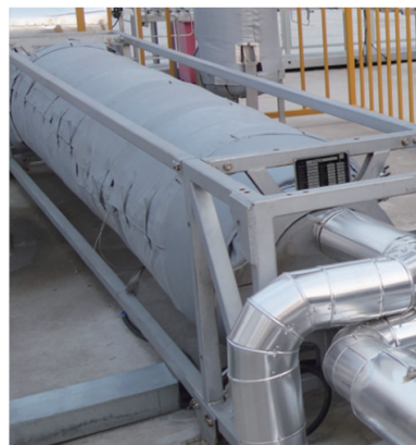
图 12 70 kg 级 Mg 基固态储氢装置原型
