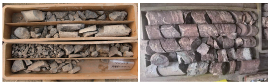
图5 强岩溶发育带和深部热储钻井岩心照片
