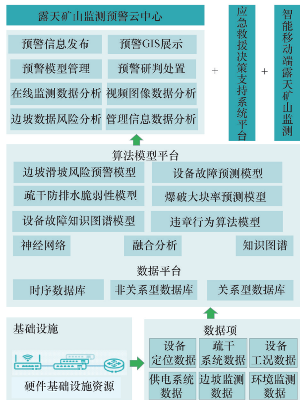
图8 露天矿山生产监测预警架构流程
