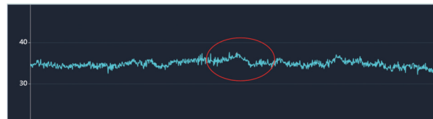
图6 南侧 L1 段光缆对应的频偏曲线
