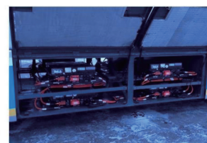
(b) 静止时打开电池舱门,确保全气候电池系统完全冻透
