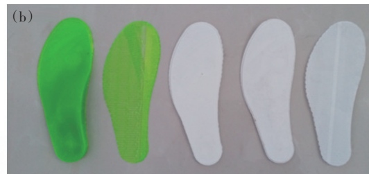
图1 熔融沉积技术原理示意(a)及其打印的鞋垫(b)
