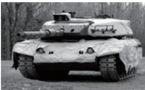
图1 基于焦耳加热的动态红外伪装系统
