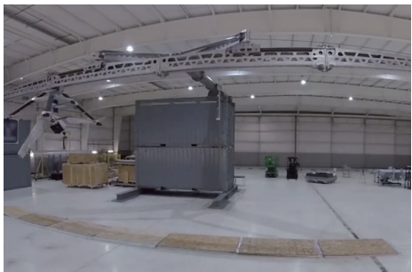
图6 侧边吊臂回收无人机试验场景
