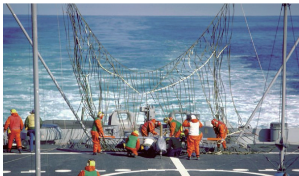
图2 无人机撞网回收方式
