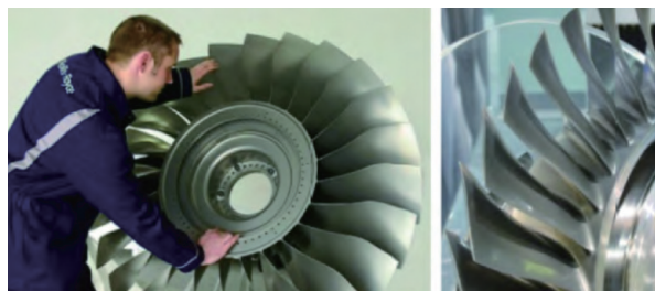
图1 Rolls-Royce公司生产的钛合金整体叶盘及其局部特征
