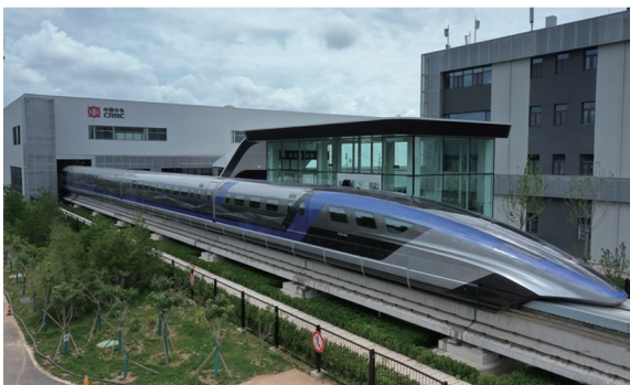
图27 时速达600 km的高速磁浮交通系统样机 (图片来源:央广网)
