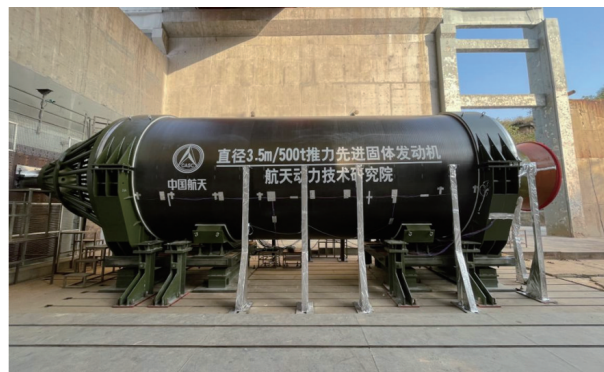
图30 直径3.5 m/500 t推力先进固体发动机
