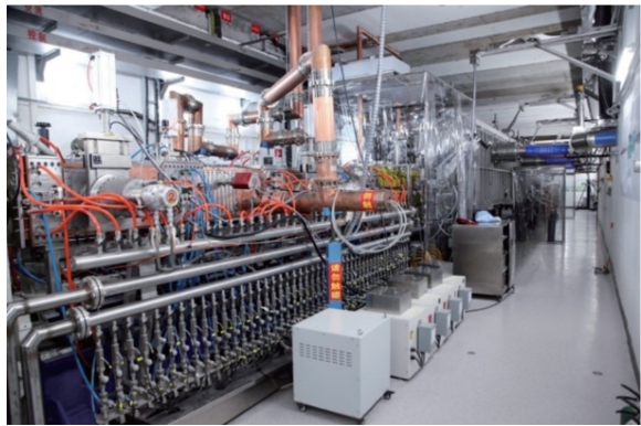
图23 ADS超导直线加速器样机 (图片来源:中国科学院近代物理研究所)
