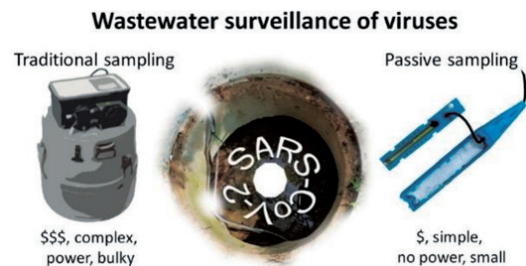
图2 用于监测污水病毒的被动采样器
