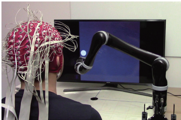
图5 用于连续随机目标跟踪的脑机接口控制机械臂系统
