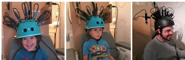
图7 装在经过改装的自行车头盔中的 光泵磁力仪测量脑磁信号
