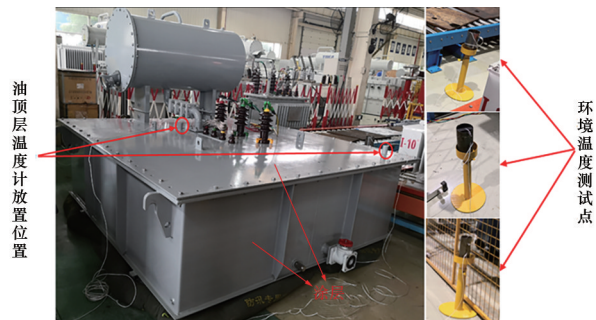
图7 变压器温升模拟试验
