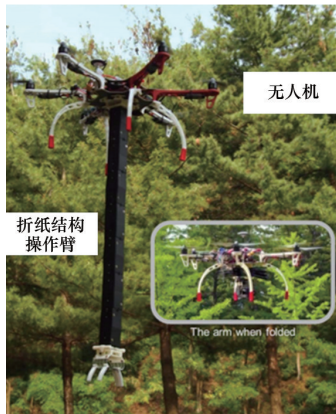
图 19 可折叠机器人手臂使无人机能够执行其他方法无法执行的任务
