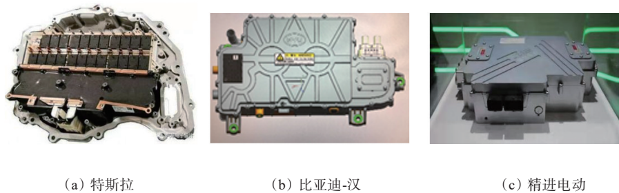
图5 电动化车辆的SiC(SiC MOSFET)控制器
