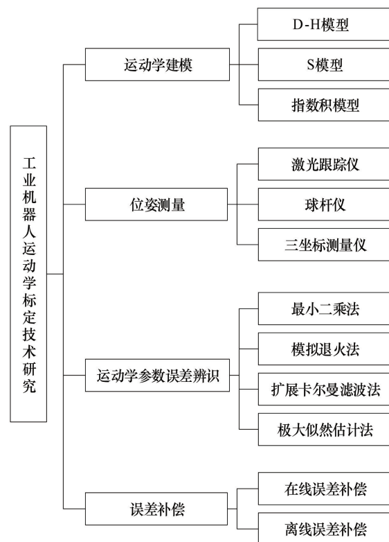
图2 绝对定位误差补偿步骤与常用方法
