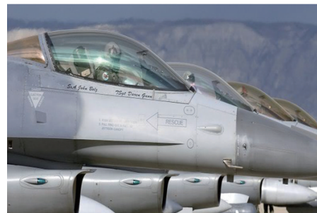
图 12 镀 ITO 膜的 F-16 座舱透明件
