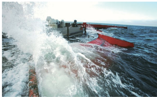
图8 Wave Dragon装置1:4.5比例样机海试
