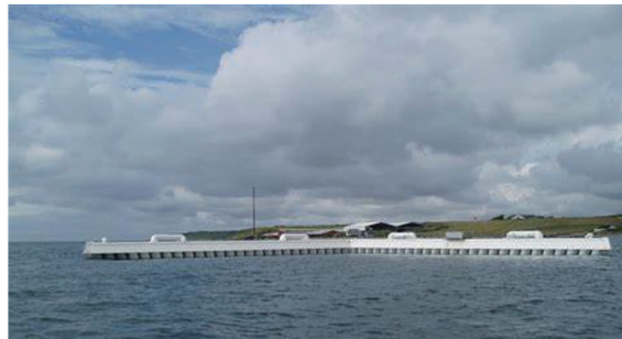
图7 LeanCon装置1:10比例样机海试
