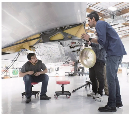
图7 将定向天线装在Sunlider机翼下部整流罩内
